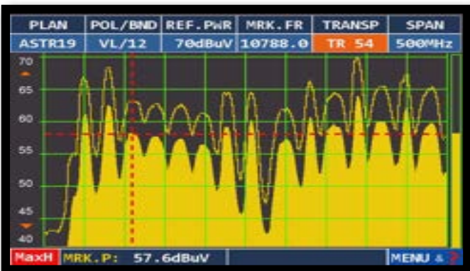
SCHNELLE SPEKTRUM ANALYSE MIT SPITZENWERT-DARSTELLUNG
